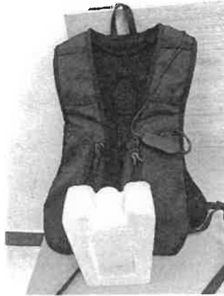
圖 8 水冷循環式背心
